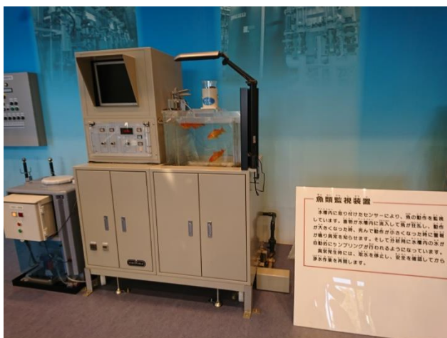
魚類監視装置
