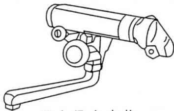
湯水混合水栓 (サーモスタット式)
