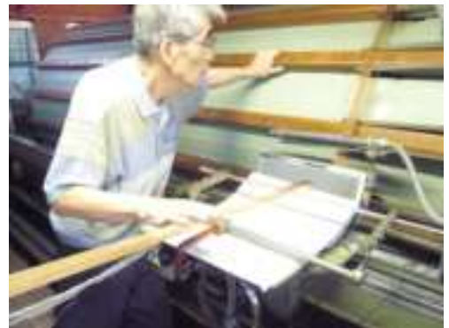
糸の張りを確かめながら整経機に巻き取る様子
