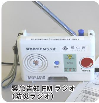
このラジオは、電源が入っていない状態でも緊急放送の信号を受信し、自動的に最大音量で情報を流した後に、電源が切れます。
